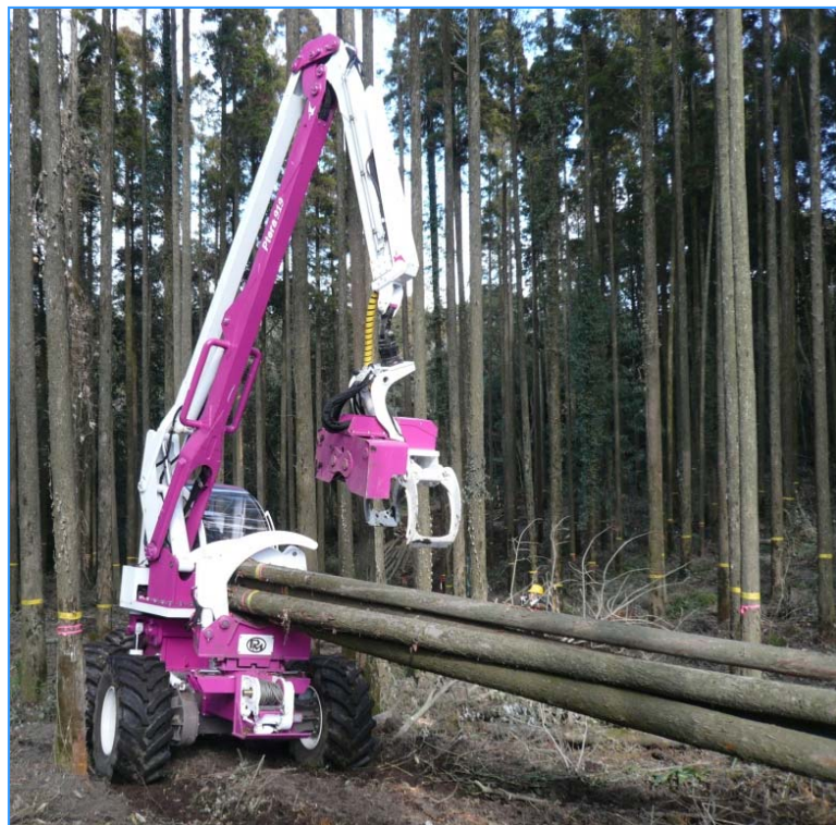
アーティクレート（中折れ）式8輪駆動林内作業車 【松本システムエンジニアリング(株)】
